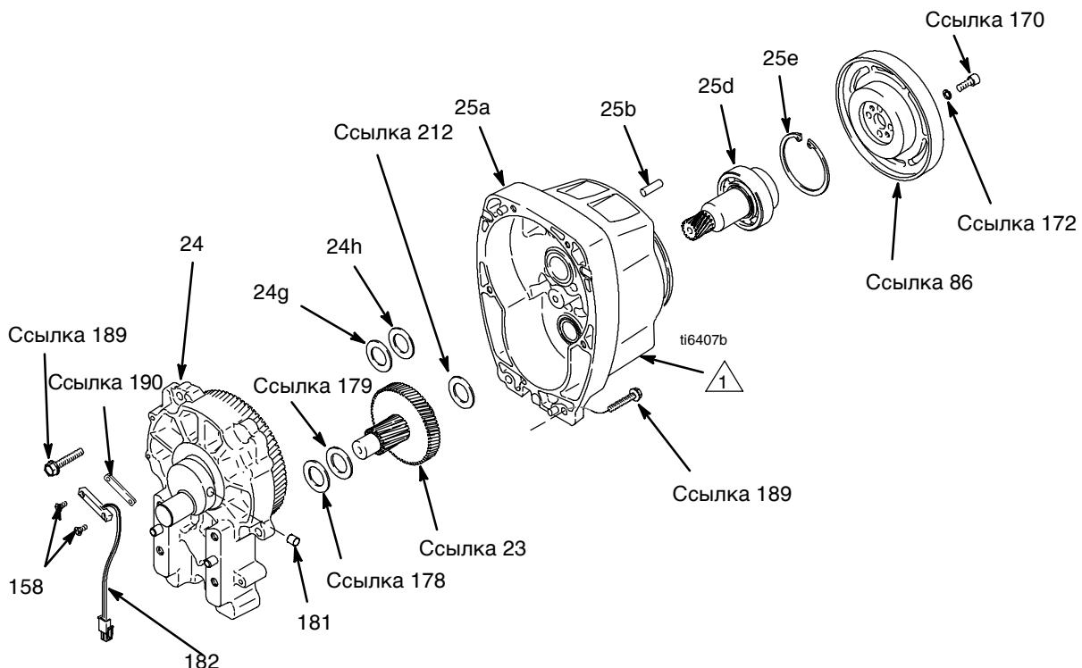
Узел корпуса шестерни (25) включает обмотку муфты сцепления и разъем
