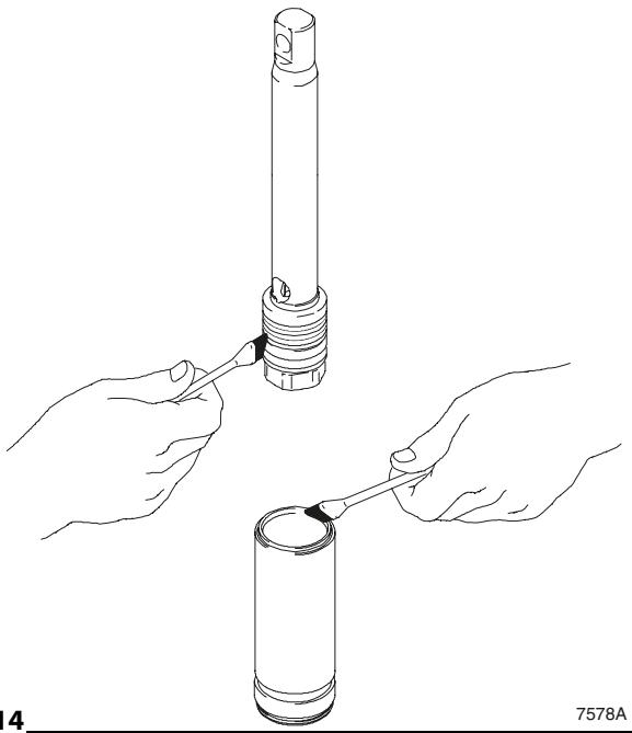
Рис. 16. Смажьте верхние два–пять сантиметров штока поршня, которые будут проходить через щелевые уплотнения цилиндра.
