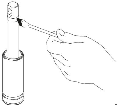
Рис. 17. Смажьте уплотнительное кольцо (221) и установите на втулку. Сдвиньте узел втулки/шток поршня в нижнюю часть цилиндра. При необходимости замените уплотнительное кольцо (207).
